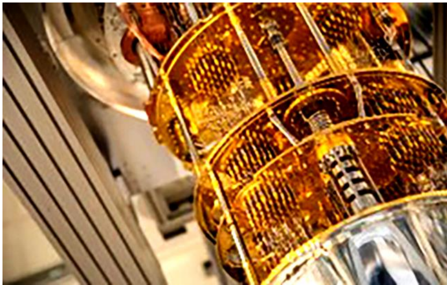
รูปที่ 5 ตู้เย็นเจือจางจริงที่ใช้ในห้องปฏิบัติการวิจัยควอนตัม แสดงแผ่นทองแดงชุบทองซ้อนกันเป็นชั้น ๆ ตามชั้นอุณหภูมิต่าง ๆ [11]
